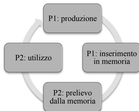
Figura 4.2–1 Cooperazione tra i processi P1 e P2: processo ciclico per lo scambio di informazioni.
