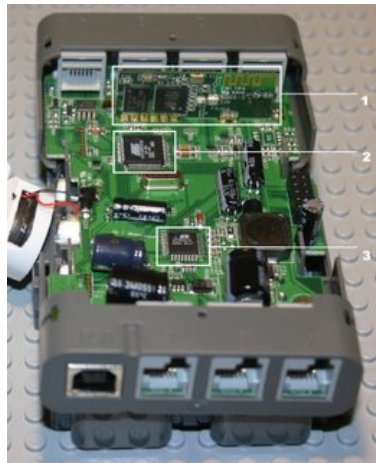
Figura 1.2: Interno NXT Brick:[1]Bluetooth, [2]Processore, [3]Coprocessore
