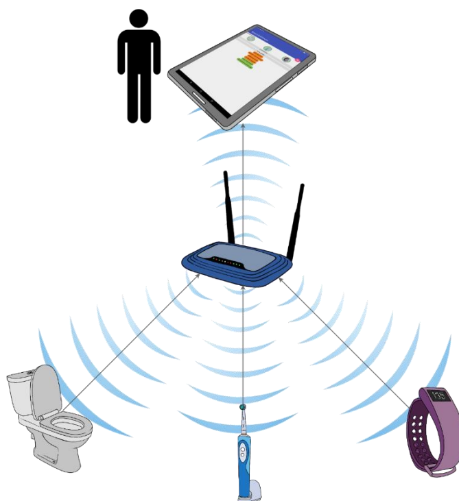
Figura 8-1- Un ipotetico bagno smart con tre elementi: un gabinetto, uno spazzolino e un dispositivo wearable, che offrono servizi evoluti grazie all'applicazione server realizzata e che possono essere interrogati da un dispositivo consumer come un tablet o uno smartphone per ricevere notifiche di alto livello elaborate a partire da dati raw.
