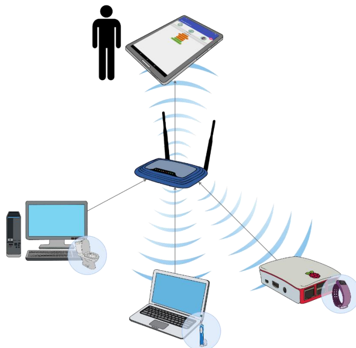
Figura 8-2- Scenario applicativo aggiornato con i dispositivi utilizzati per la simulazione dei vari elementi del bagno smart
