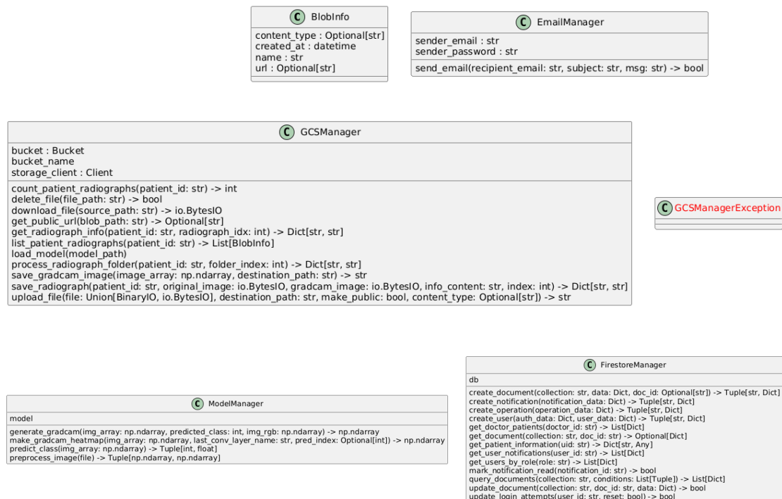
Figura 10: Diagramma delle classi: modulo Utility
