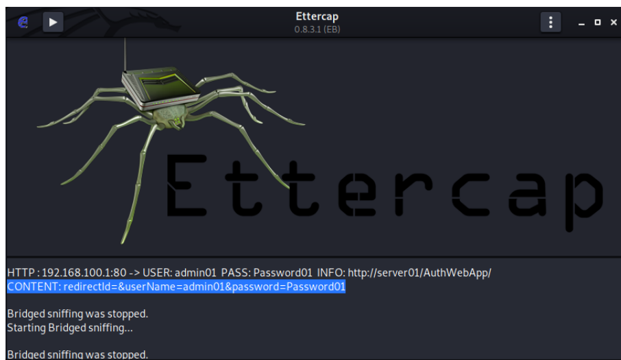
Figura 9: Credenziali di autenticazione di AuthWebApp, che utilizza l'http con Apache, configurato come reverse proxy per Tomcat, in ascolto nella porta TCP 80, catturate da Ettercap.
