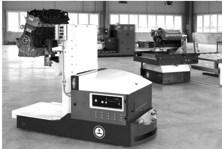
Fig.1: foto di un veicolo industriale a guida automatizzata. [15]
